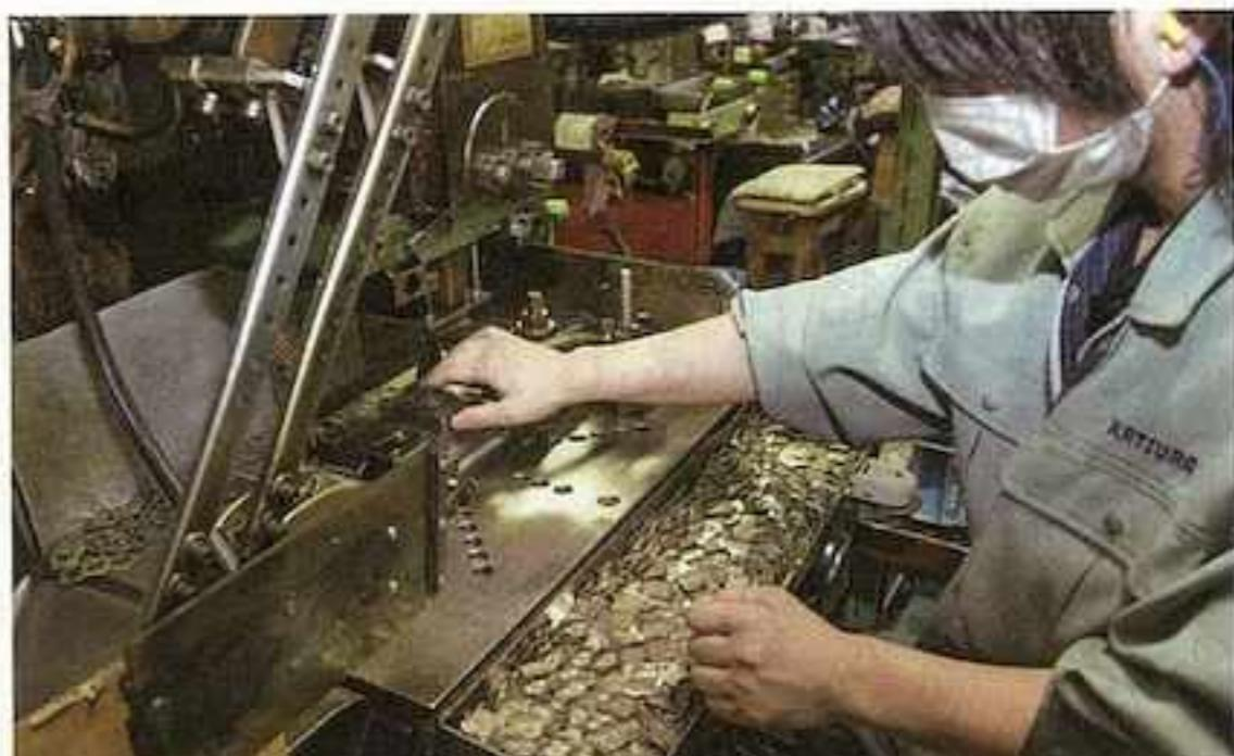
プレス機で1枚ずつ金属片を打ち抜く従業員
