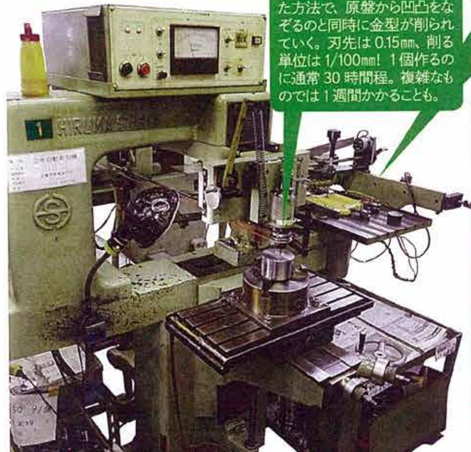
金型ができたら、いよいよ実際の素材を加工していく。ここからは、「真鍮プレス」の方式で、『五稜郭タワー』のキーホルダーを作る工程に密着！
