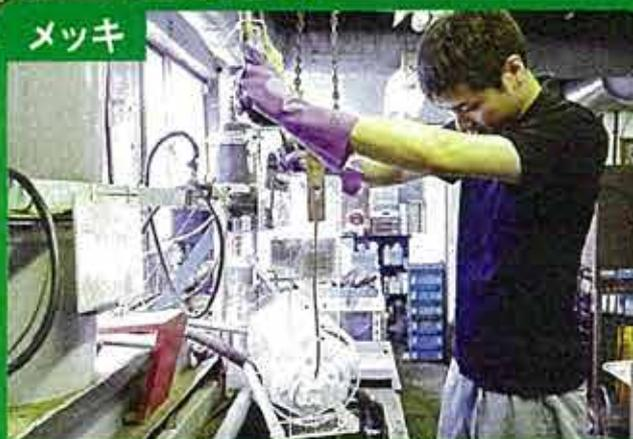
マイナス電気が流れる銀を含む溶液に浸ける。電流を流すことで、表面に銀の膜ができる。電圧や電流量によって膜の厚みを調整する。
